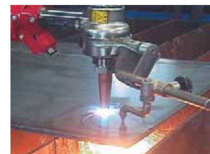
Compas petit rayon pour coupe circulaire (ø 30 mm ~ ø 200 mm)
